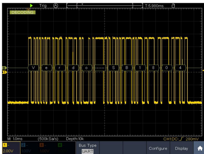
Рисунок 13 декодирование протокола rs232/uart с помощью осциллографа Verdo SB1804
