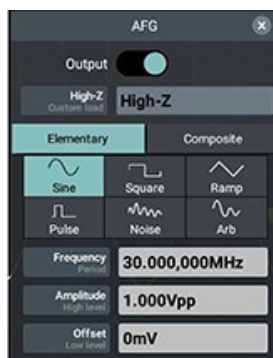
Рисунок 11 меню управления встроенным генератором сигналов в осциллографе серии Verdo SB1500
