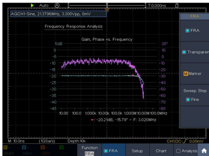
Рисунок 12 снятие ачх пассивного пробника (1:1) с помощью графика бодэ на осциллографе Verdo SB1804
