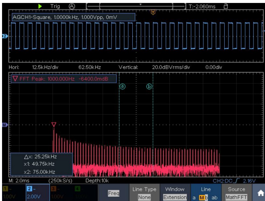
Рисунок 10 режим бпф в осциллографе Verdo SB1804
