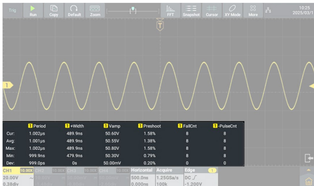
Рисунок 7 режим статистики автоизмерений в осциллографе Verdo SB1521
